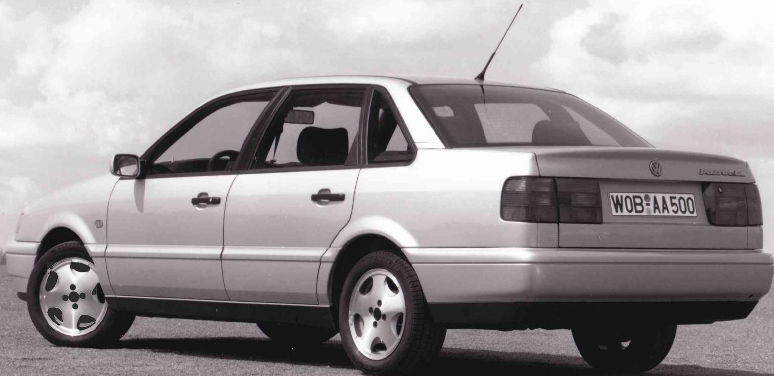
Kraftvoll zeigt sich das neugestaltete Heck der Passat Limousine, bestückt mit großen Heckleuchten. Eine ausgeprägte Abrißkante am Kofferraumdeckel erübrigt bei allen Versionen den Heckspoiler.
