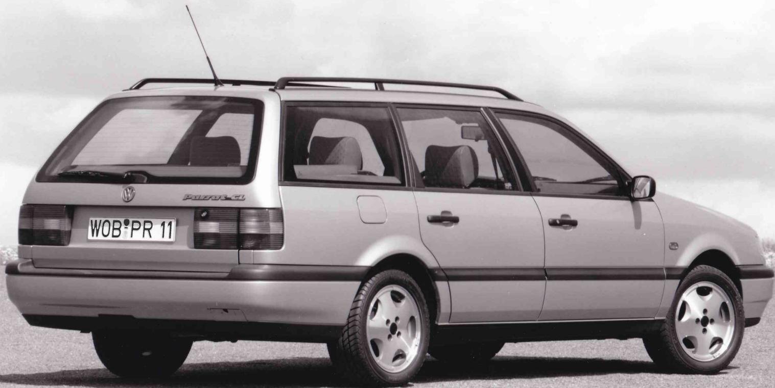
Als Antriebe für den Passat bietet Volkswagen auch beim Variant fünf Benzinmotoren und zwei Turbodiesel an. Damit wird ein Leistungsbereich von 55 kW (75 PS) bis 128 kW (174 PS) abgedeckt. Als besonders sparsam (5,3 l/100 km im Drittelmix) ragt der neue Turbodiesel-Direkteinspritzer (1,9 l Hubraum, 66 kW/90 PS) heraus. Vom Variant gibt es auch wieder eine allradgetriebene syncro-Version, zunächst mit dem 85 kW/115 PS-Vierzylindermotor.
