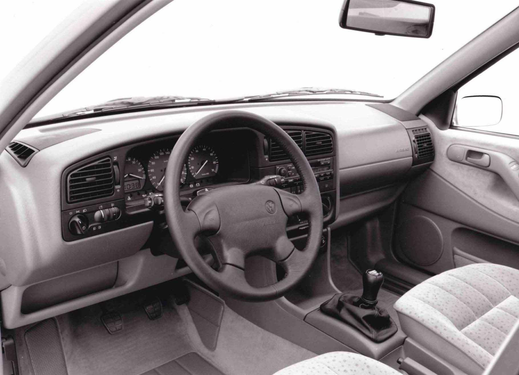
Augenfällig im Cockpit des neuen Passat ist links vom Lenkrad der Kombischalter für die Beleuchtung. Mit einem besonderen Dreh integriert er die Bedienung von Nebelscheinwerfer und Nebelschlußleuchte. Beim Drehen nach rechts wird erst das Begrenzungs- und dann das Fahrlicht geschaltet. Ein Ziehen schaltet in zwei Stufen Nebelscheinwerfer und -schlußleuchte zu. Vorteil: Mit Ausschalten der Scheinwerfer erlischt auch die Nebelbeleuchtung, die sonst oft vergessen wird.
