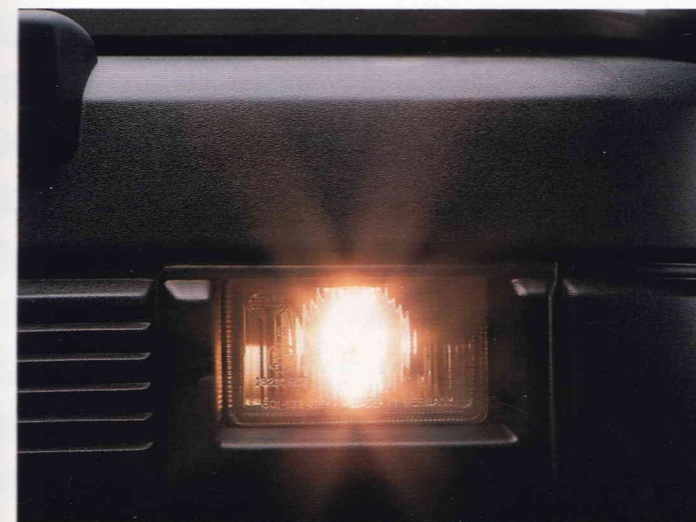
Die Nebelscheinwerfer. Bessere Sicht bei Nebel und starkem Schneefall. Harmonisch in den Stoßfänger integriert (Serie GT).
