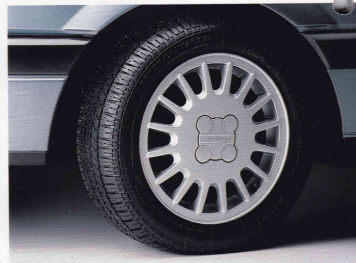
Das Leichtmetallrad 6 J x 15. Mit Mittenabdeckung. Sportliches Design. Geringeres Gewicht.
