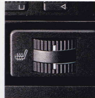
Die Sitzheizung. Spricht besonders schnell an, dadurch behagliches Sitzen, insbesondere bei Kaltstart im Winter. Temperatur kann für beide Vordersitze getrennt geregelt werden.
