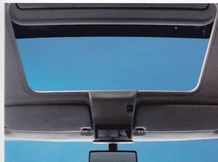
Das Schiebe-/Ausstelldach. Elektrisch zu betätigen. Öffnen oder aufstellen des hinteren Teils. Mit selbstaufstellendem Windabweiser gegen Zugluft.
