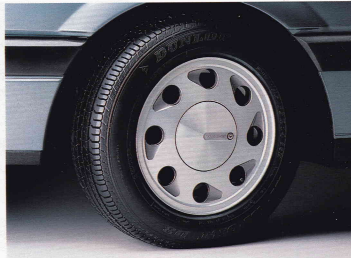
Das Leichtmetallrad 6 J x 14. Mit Mittenabdeckung. Sportliches Design. Geringeres Gewicht.
