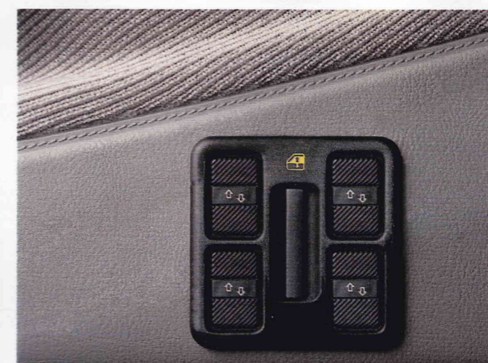
Die elektrischen Fensterheber. Alle Seitenscheiben per Knopfdruck öffnen und schließen. Mit Kindersicherung für die hinteren Fenster. Auch in Kombination elektrische Fensterheber vorn, manuell betätigte hinten.
