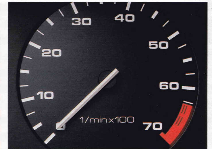
Der Drehzahlmesser. Sichere Anzeige, um den Motor im günstigen Drehzahlbereich zu halten und somit besonders kraftstoffsparend zu fahren.
