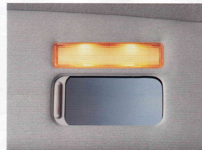
Der Make-up-Spiegel. Beleuchteter Spiegel in der Sonnenblende für Fahrer- und Beifahrerseite. Auch nur für Beifahrerseite.
