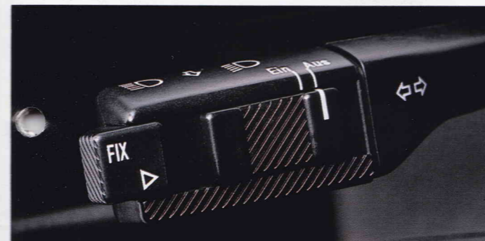
Die Geschwindigkeits-Regelanlage. Zur Programmierung der gewünschten Geschwindigkeit. Der Fahrer kann jede Geschwindigkeit ab 40 km/h als Konstante eingeben.
