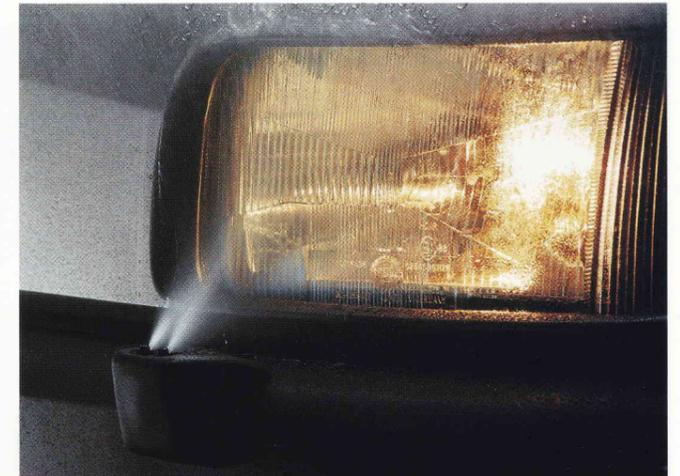
**Die Scheinwerfer-Reinigungsanlage** Mehr Sicherheit durch gute Sicht.
