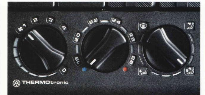
**Die Thermotronic.** Automatische Heizungsregelung. Die gewünschte Innentemperatur wird schnellstmöglich erreicht und konstant gehalten. Nachregeln der Heizung von Hand überflüssig.
