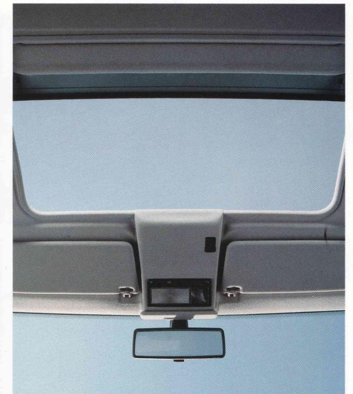
**Das Schiebe-/Ausstelldach.** Elektrisch zu betätigen. Öffnen oder aufstellen des hinteren Teils. Mit selbstaufstellendem Windabweiser gegen Zugluft und beleuchteter Make-up-Spiegel für Fahrer- und Beifahrerseite.
