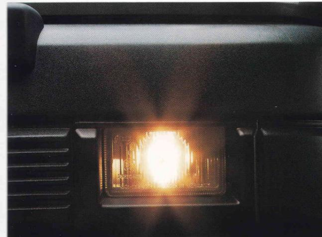
**Die Nebelscheinwerfer.** In DE (Dreiellipsoid)-Technik mit hellerem Licht für noch bessere Sicht bei Nebel und starkem Schneefall. Harmonisch in die Stoßfänger integriert (Serie bei GT und GT syncro G60).
