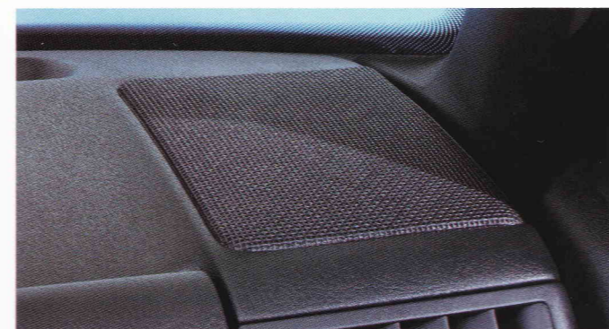
Sound zum ersten. Bei der Radioanlage „alpha“ sind in der Armaturentafel 2 Breitbandlautsprecher mit 100 mm Durchmesser eingebaut.
