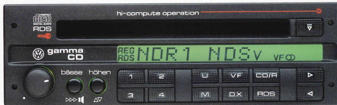
**Das Radio-Cassettengerät „gamma CD“.** Mit Sendersuchlauf, 4 Stationstasten für je 4 MW-/UKW-/VF-Sender, Radio-Data-System (RDS), getrennter Höhen- und Tiefenregelung, Tipptastenbedienung, Display in Punktmatrix-Darstellung, Antidiebstahl-Maßnahmen. CD-Laufwerk mit 1-Strahl-Laser-Abtastsystem, Titelwahl und
