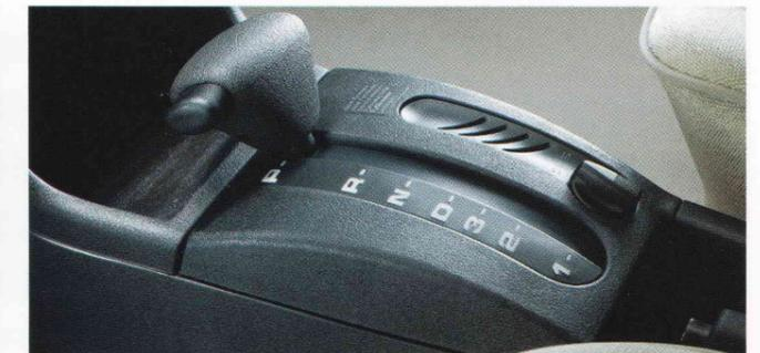
**Die elektronisch/hydraulisch gesteuerte 4-Stufen-Automatik.** Mit Wandlerumgebung in der 3. (ab 50 km/h) und 4. Fahrstufe. Zwei Fahrprogramme (Sport/Economy). Bessere Beschleunigung und geringerer Kraftstoffverbrauch.
