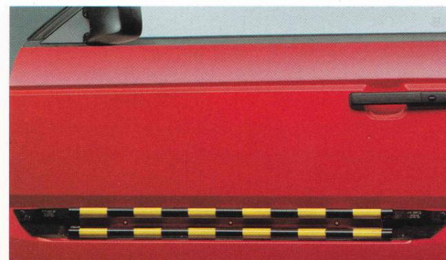
Versehen den Passat mit Versteifungsprofilen in den Türen. Was die seitliche Kollisionssicherheit erhöht. Statten ihn z. B. mit einer teleskopierenden Lenksäule, einem energieabsorbierenden Sicherheitslenkrad aus. Und auf Wunsch mit dem Volkswagen Airbag für Fahrer und Beifahrer.
