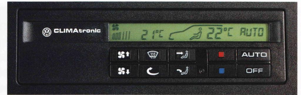
**Die Klimaanlage.** Besonders hohe Kühlleistung. Wahlweise Frischluft- oder, z.B. im Stau, Umluftbetrieb. Wirkungsvoller Zusatzeffekt: Die Scheiben bleiben beschlagfrei. Es gibt sie in 2 Ausführungen: manuell regelbar oder als „Climatronic“ vollelektronisch gesteuert.
