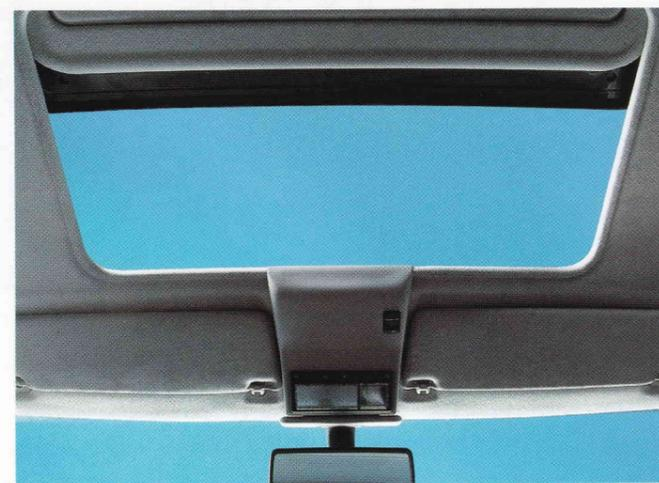
**Das Schiebe-/Ausstelldach.** Elektrisch zu betätigen. Öffnen oder aufstellen des hinteren Teils. Mit selbstaufstellendem Windabweiser gegen Zugluft und beleuchteter Make-up-Spiegel für Fahrer- und Beifahrerseite. Auch als Glasdach mit Jalousie.
